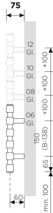
Position für den elektrischen Heizstab (Leistung nach Heizkörpergröße) ●
